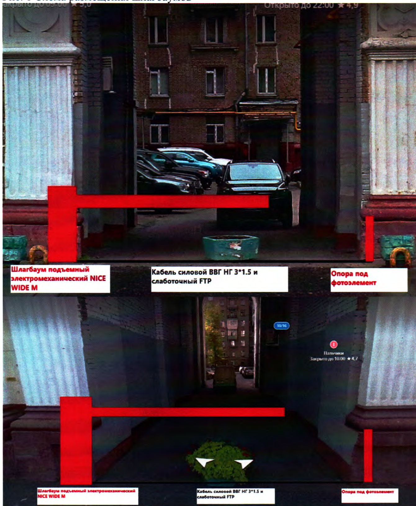
Рис. 1 Схема размещения шлагбаумов
