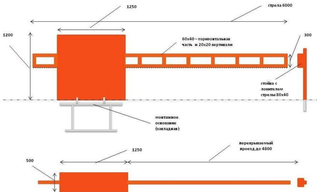
Шлагбаумы крепятся болтами на металлическую закладную вмонтированную в бетонное основание. На стойке шлагбаумов находится электромеханический привод, а также блок электронного управления. Привод, перемещающий стрелу, состоит из электродвигателя, редуктора. Шлагбаумы снабжены регулируемыми элементами безопасности, а также устройством фиксации стрелы в любом положении и ручной расцепитель для работы в случае отсутствия электроэнергии.
