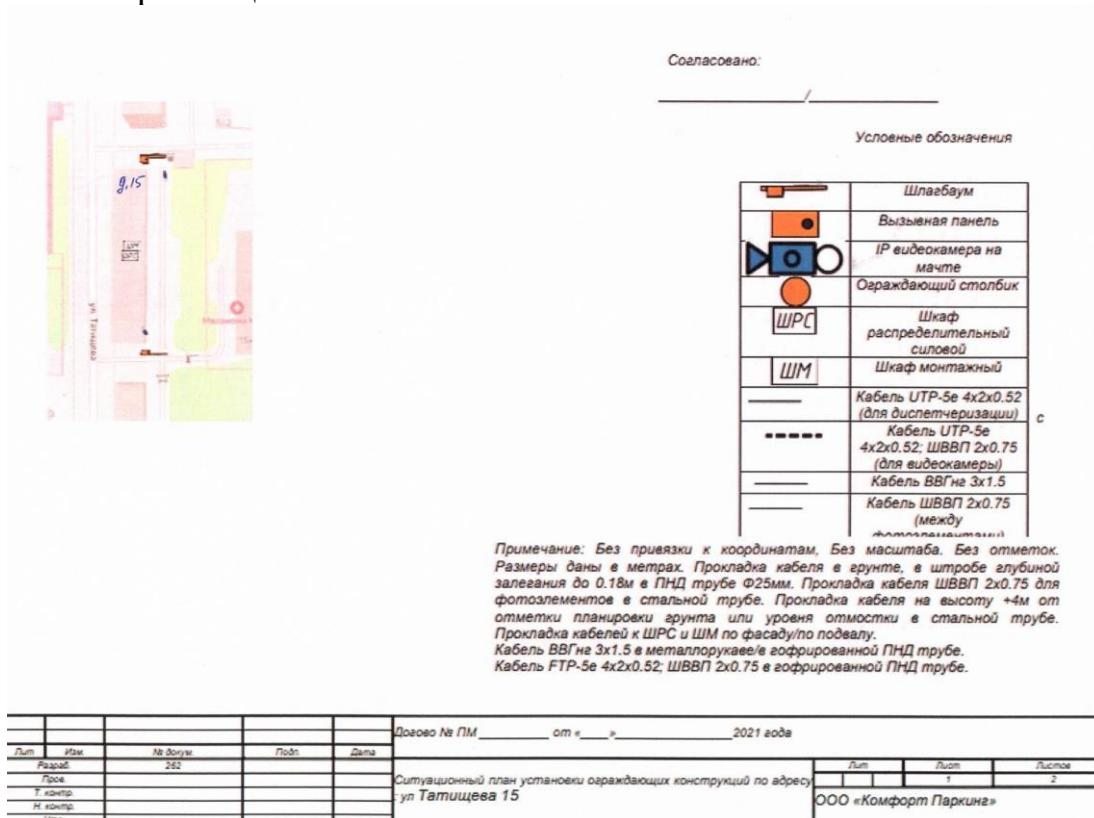
2. Тип ограждающих устройств: антивандальный (откатной) шлагбаум (автоматический с электромеханическим приводом движения стрелы).
