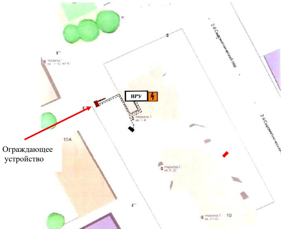
**Тип ограждающего устройства: антивандальный автоматический подъемный шлагбаум**
