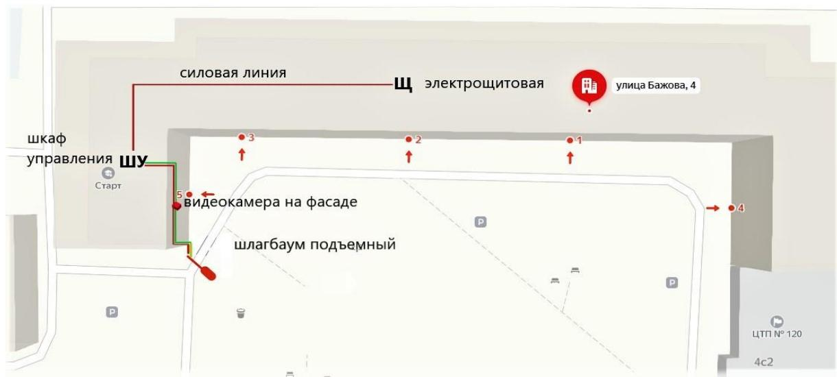
**Тип шлагбаума:** Электромеханический подъемный шлагбаум NICE WIDE-M и механический ручной поворотный ШГУ-1-5.
