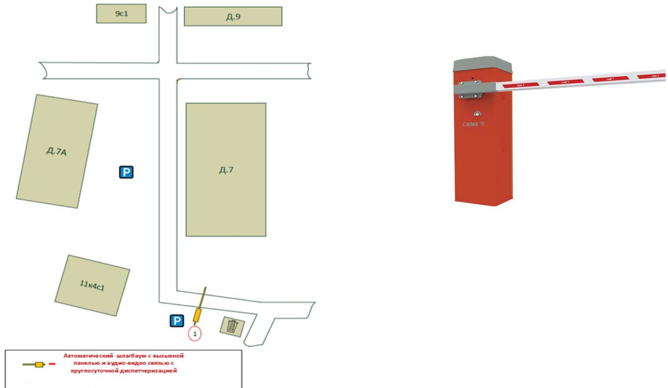
1. Шлагбаум автоматический с электромеханическим приводом поднятия и опускания стрелы;
